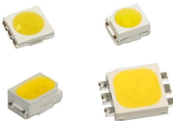
Рис. 1.6. Зовнішній вигляд освітлювальних світлодіодів типу SMD.
