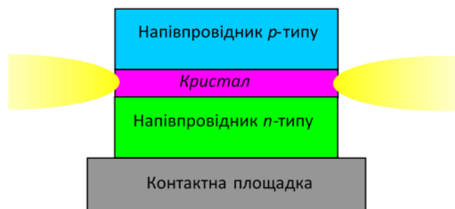
Рис. 3.5. Схематична будова напівпровідникового світлодіода.
