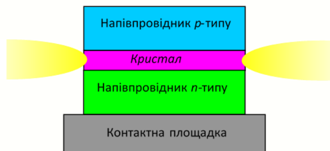
Рис. 2.5. Вивільнення квантів світла з активної зони СД.
