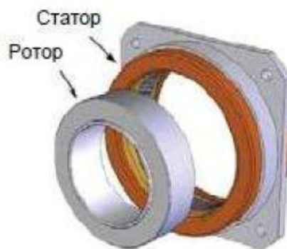
Рисунок 1.3 – Традиційна конструкція моментних двигунів
