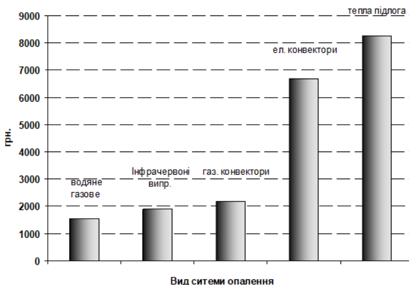
Рисунок 3.7 – Ефективність систем опалення в залежності від вибору теплоносія
