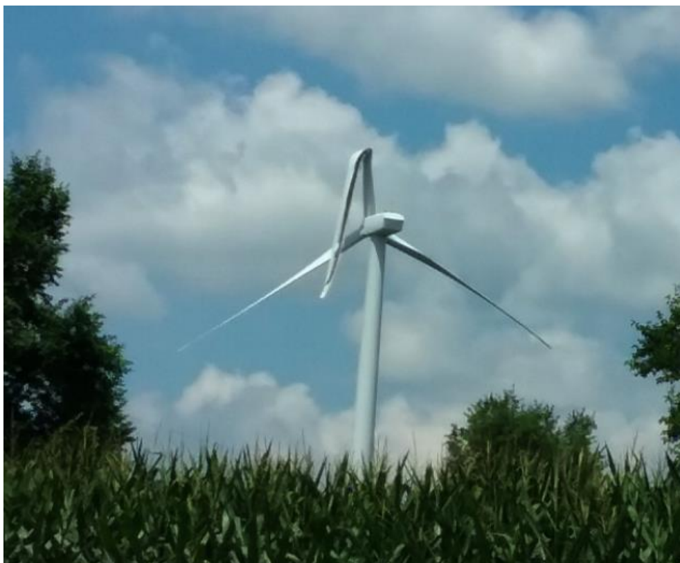
Рисунок 3.6 – Погнута лопать вітрової турбіни в Айові, США
