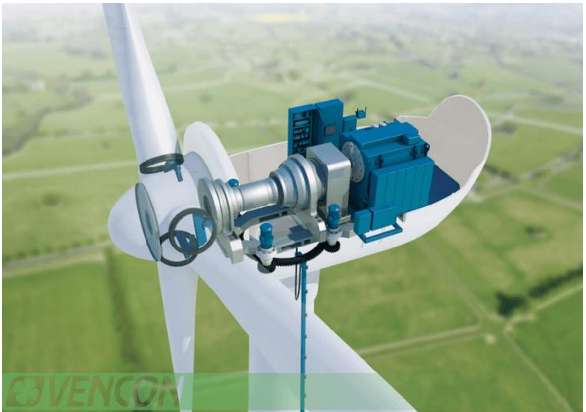
Рисунок 1.2 – Компоненти вітрової турбіни
