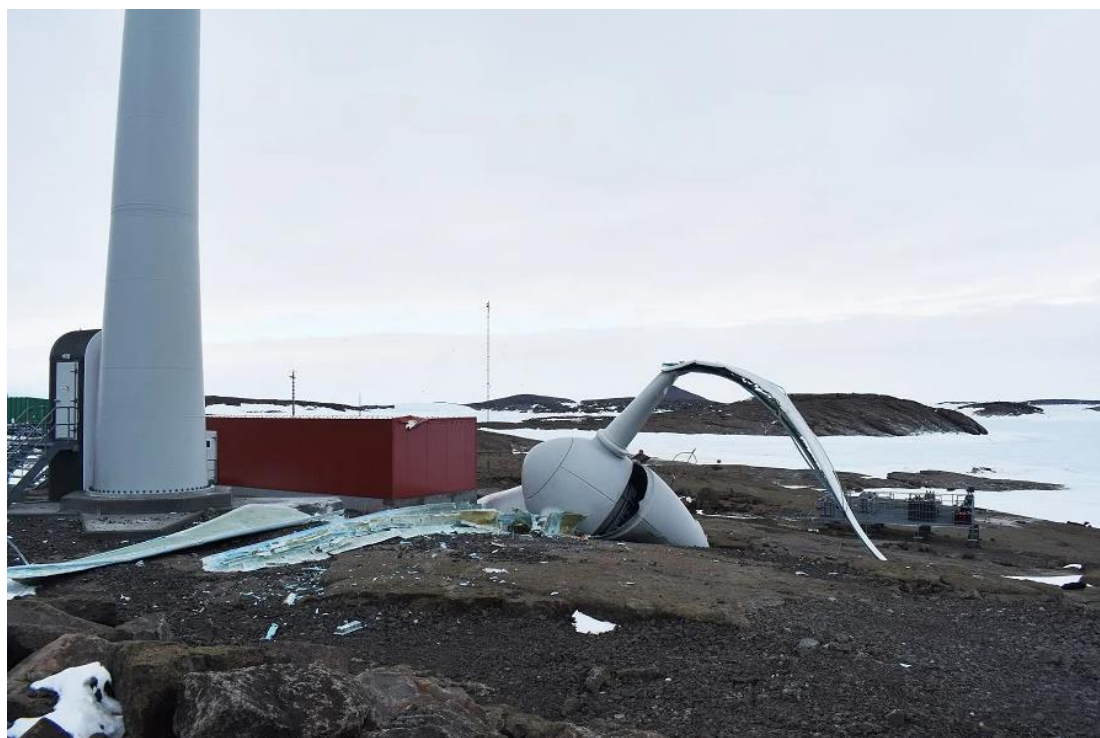
Рисунок 3.5 – Ротор відвалився від вітрової турбіни в Антарктиді
