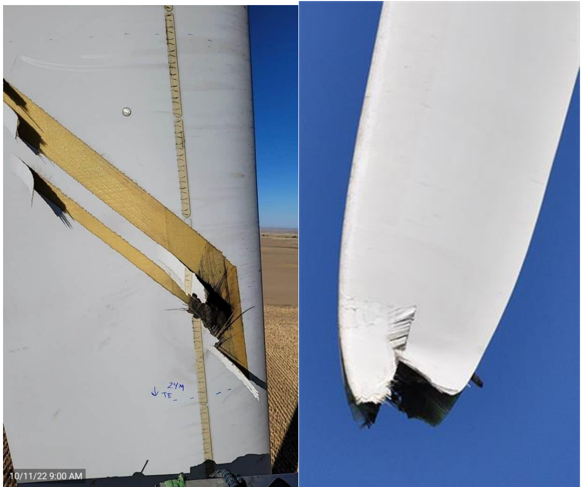
Рисунок 2.7 – Пошкодження лопаті турбіни від ураження блискавкою
