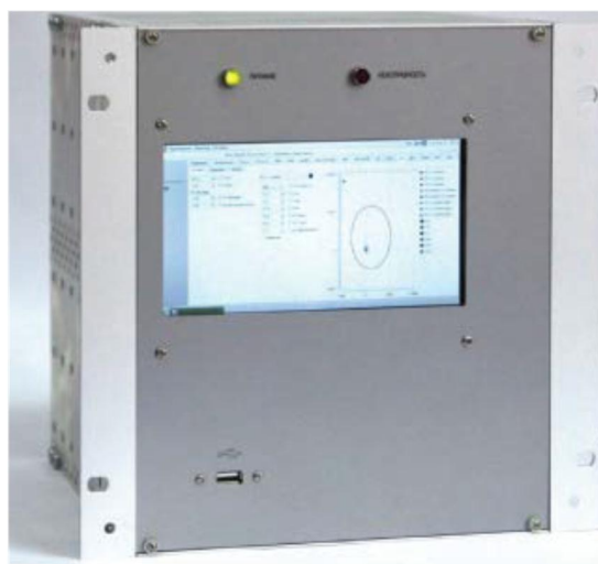
Рисунок 1.3 – Зовнішній вигляд інтелектуального електронного пристрою
