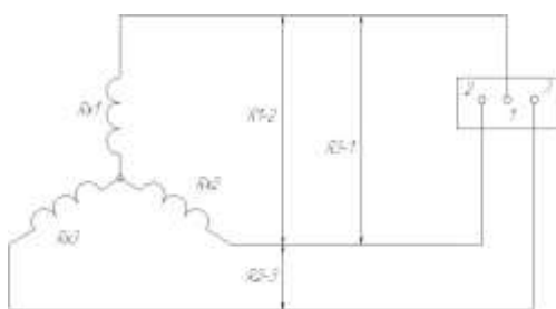
Рисунок 5.2 – Схема для вимірювання опору обмотки при з'єднанні фаз в зірку
