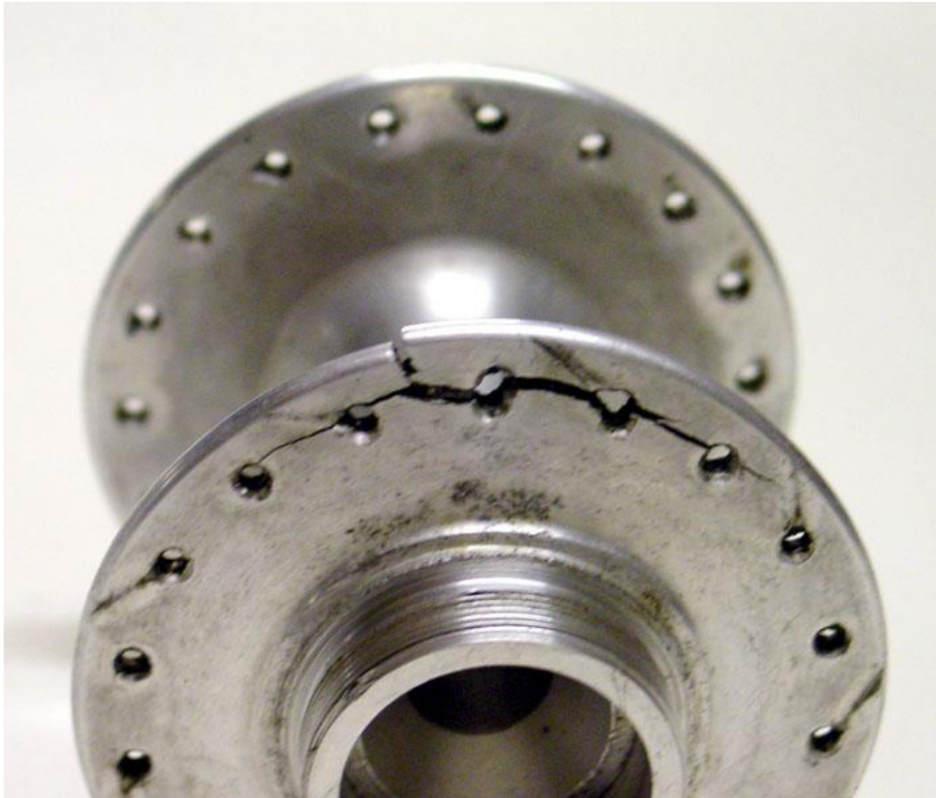
Рисунок 4.3 – Пошкодження деталі в результаті втомного зношування
