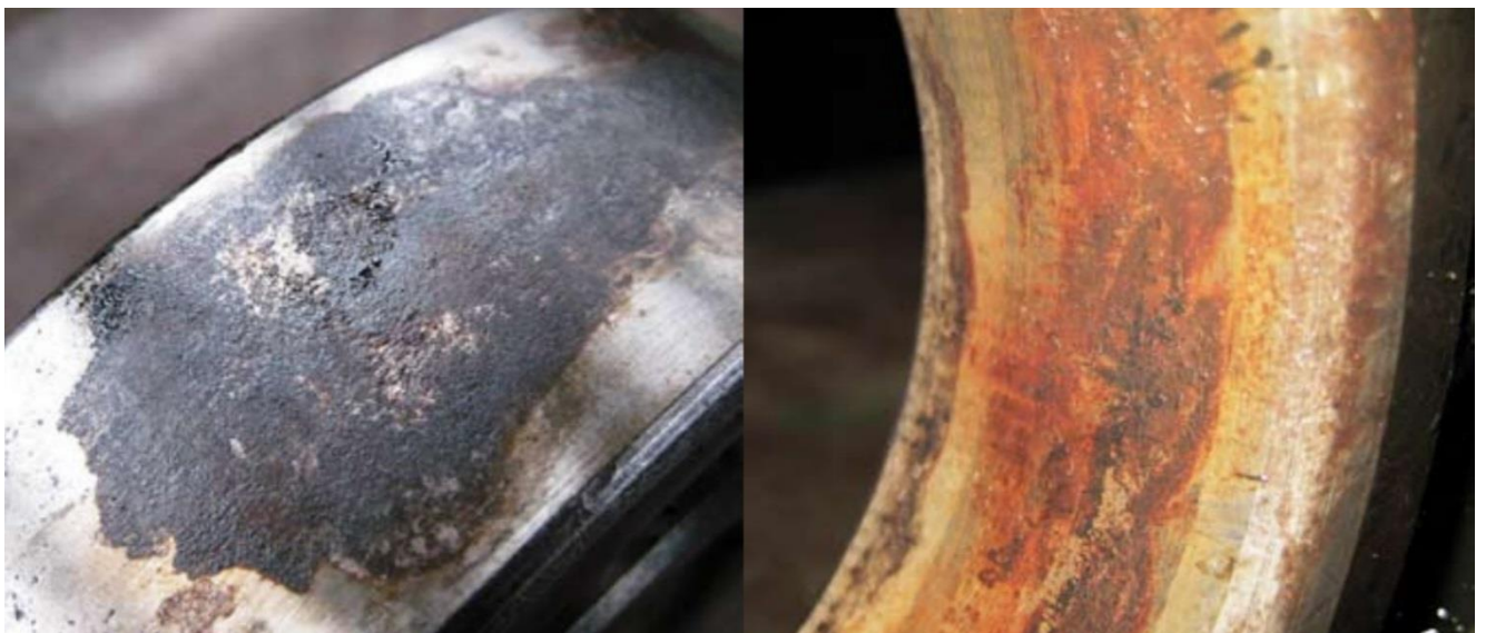
Рисунок 4.4 – Пошкодження деталей в результаті фретінг-корозії
