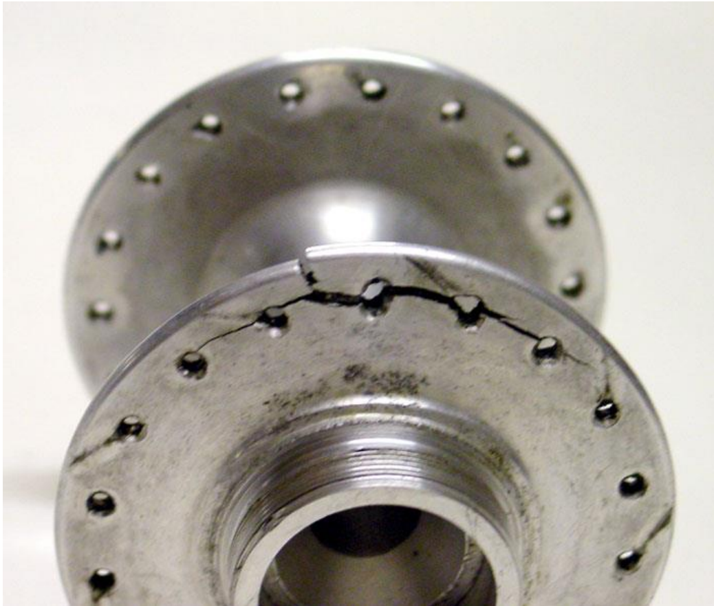
Рисунок 4.3 – Пошкодження деталі в результаті втомного зношування
