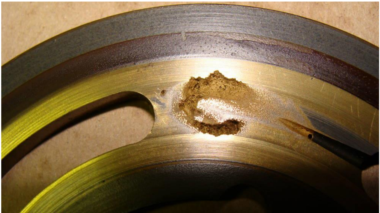
Рисунок 4.2 – Пошкодження пластини клапана аксіально-поршневого гідронасоса в результаті кавітаційного зношування
