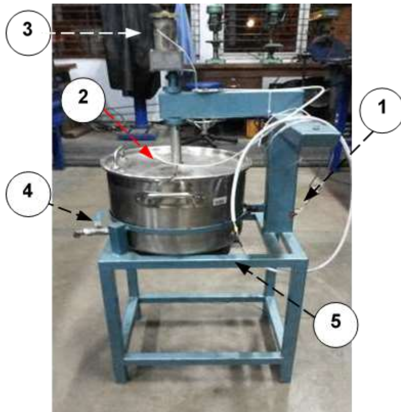
Рисунок 1.3 - Механічна конструкція системи для пастеризації молока.
