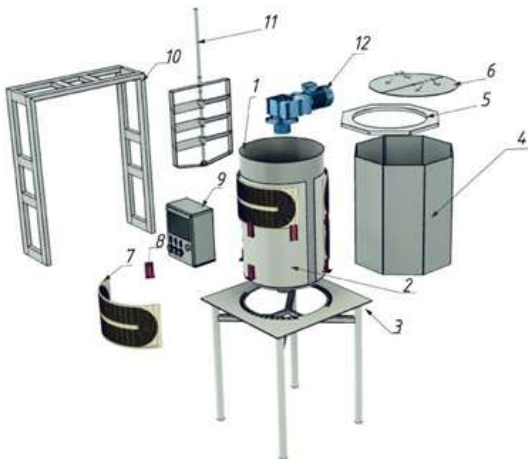
Рисунок 2.1 - Розподілена схема прототипу пастеризатора: 1. Бак; 2. Кришки бака; 3. Опорний стіл; 4. Корпус; 5. Верхня частина корпусу; 6. Кришка; 7. Рама індуктора; 8. Кріплення рами індуктора; 9. Корпус блоку живлення; 10. Монтажна стійка; 11. Мішалка; 12. Електродвигун.
