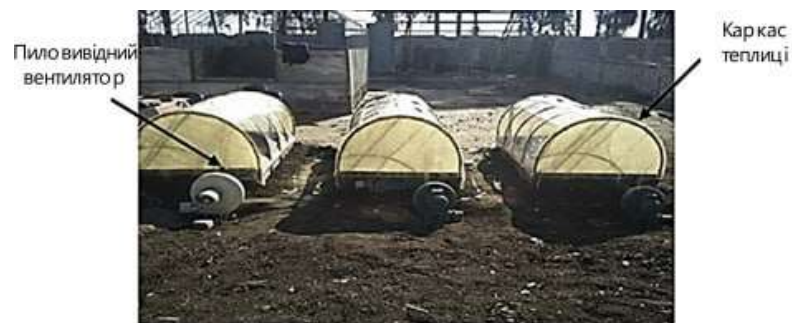
Рисунок 3.6 - Сонячна тунельна теплична сушарка
