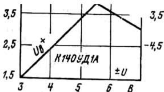
Рисунок 2.20 - Залежність максимальних вихідних напруг ОП К140УД1 від напруги джерела живлення
