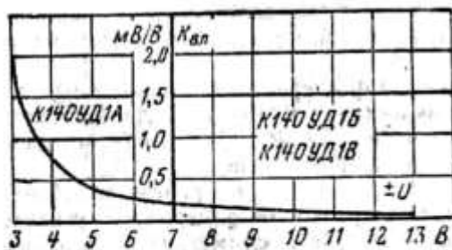
Рисунок 2.17 - Залежність коефіцієнта впливу джерела живлення на напругу зміщення ОП К140УД1 від напруги джерела живлення
