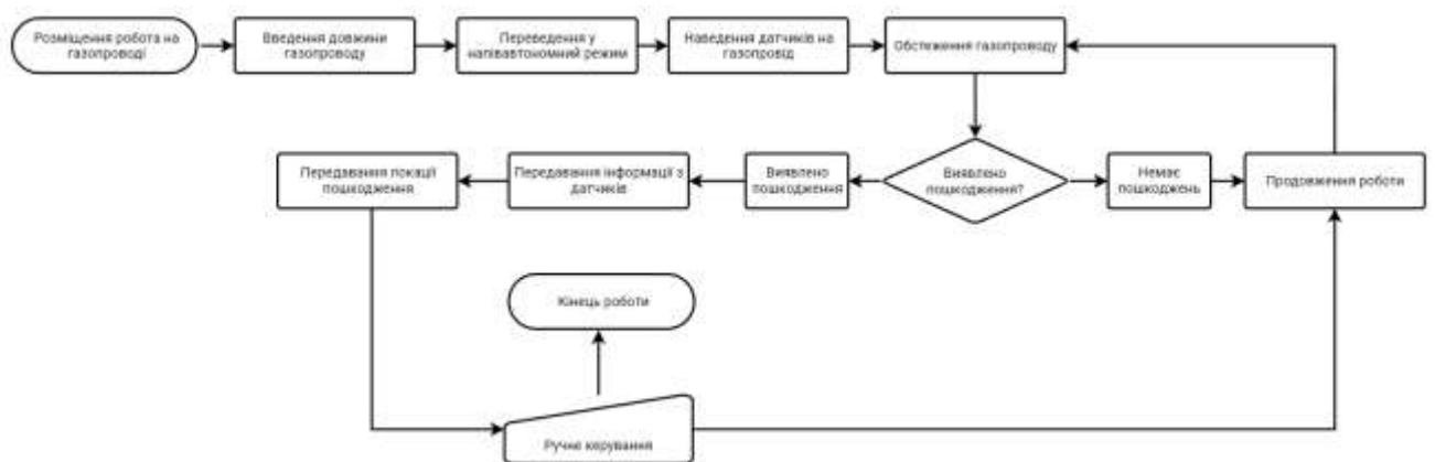
Рис. 2.17 Блок-схема логіки мобільного робота
