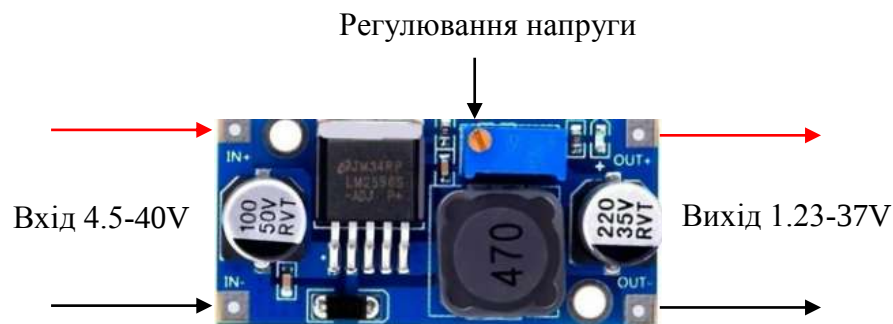
Рис. 2.11 Принцип роботи LM2596S DC-DC
