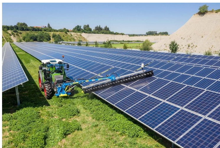
Рисунок 1.10 - Повне автоматичне очищення сонячних панелей за допомогою Sun Brush.
