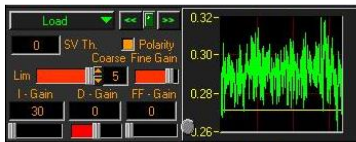
Рис. 3.7. Елемент панелі налаштувань «Servo»
