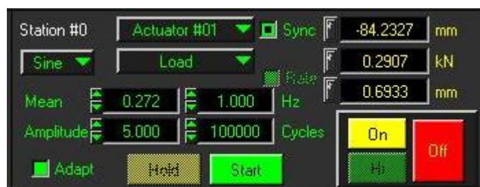
Рис. 3.10. Панель Console (параметри експерименту)
