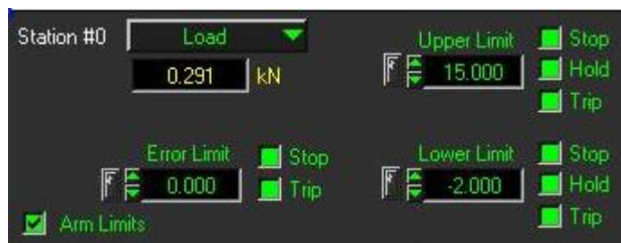
Рис. 3.9. Елемент панелі налаштувань «Limits» (встановлення меж)
