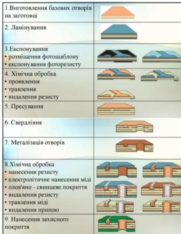
Рисунок 1.32 – Стандартні операції комбінованих методів виготовлення ДП
