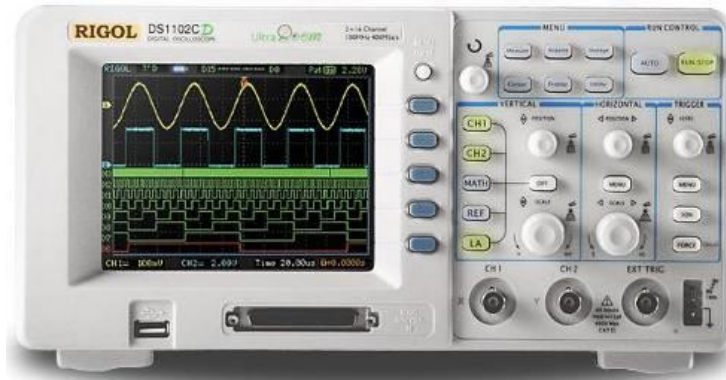
Рисунок 1.3 – ЦО змішаних сигналів RIGOL DS1102CD
