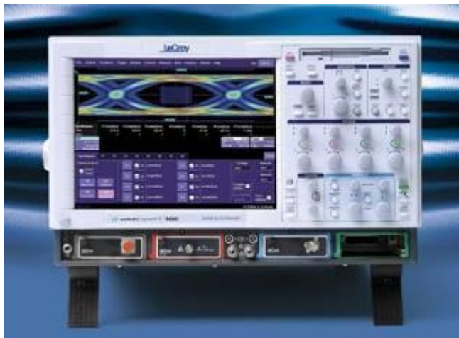
Рисунок 1.7 – Осцилограма на екрані стробоскопічного ЦО
