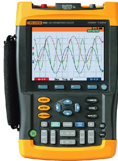
Рисунок 1.9 – Портативний осцилограф Fluke 199C
