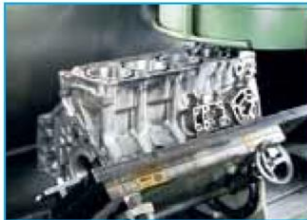
Рис. 2.12. Згладжування поверхні блоку.
