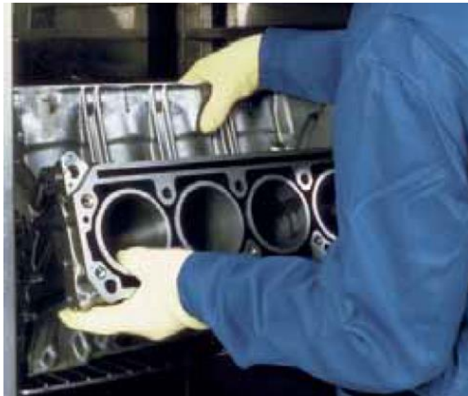
Рис. 2.11. Блок двигуна розміщують у печі.
