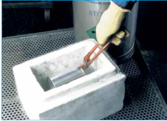
Рис. 2.10. Гільза поміщається в рідкий азот.
