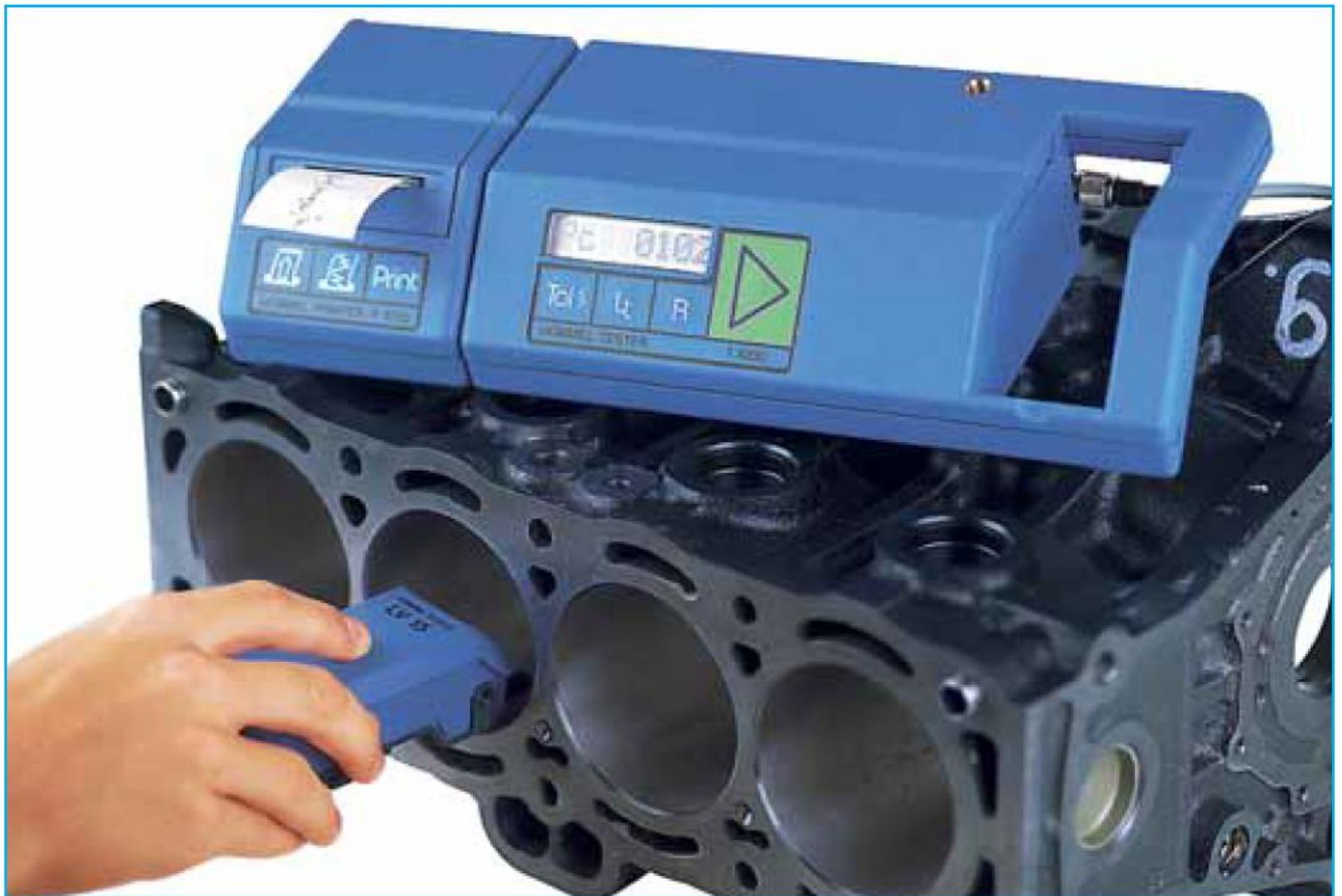
Рис. 1.4. Приладом для виміру шорсткості
