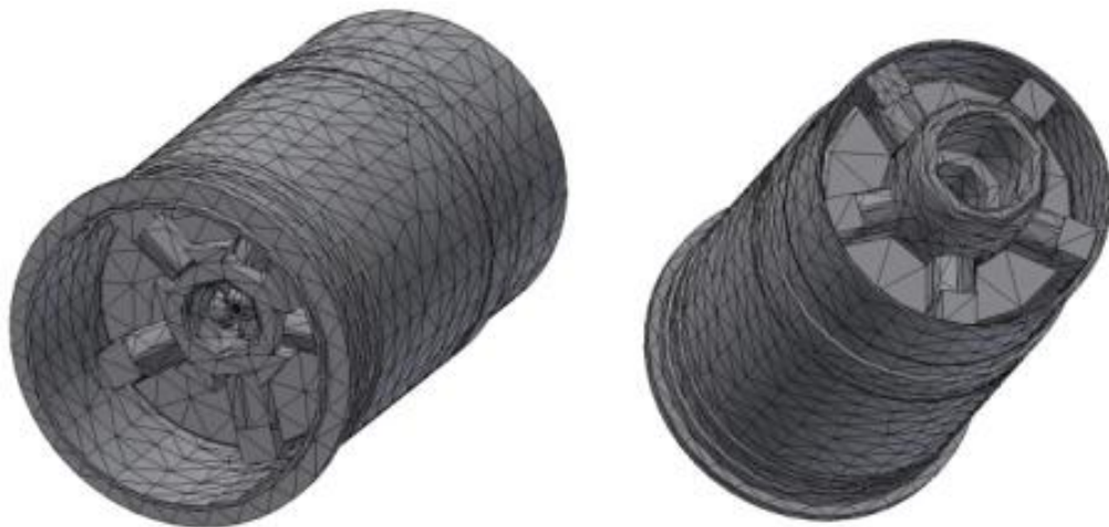
Рис. 3.5. 3D-модель головки для хонінгування та циліндра з вимірювальною сіткою для числового моделювання методом метод скінченних елементів.
