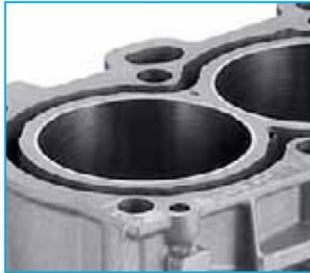
Рис. 2.9. Блок двигунів з окремими циліндровими трубами.
