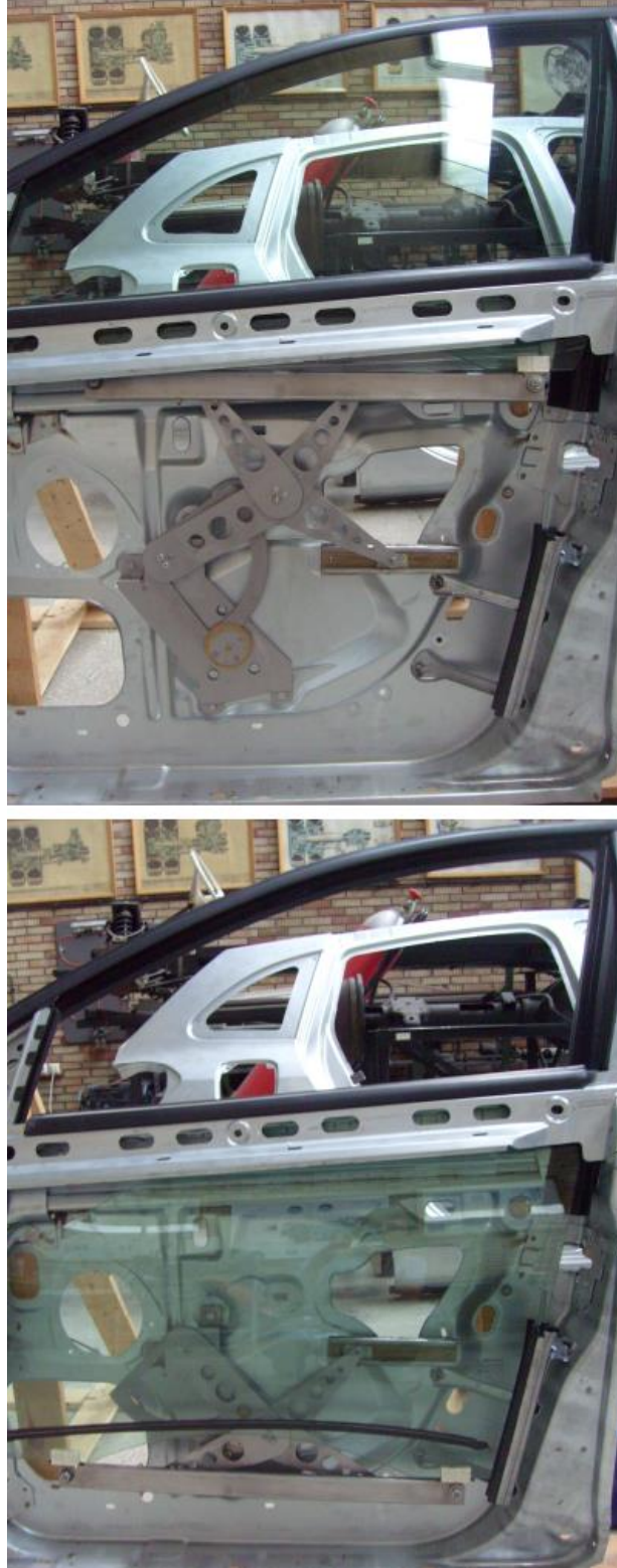
Рис. 3.9. Зібраний прототип регулятора вікна на шасі дверей автомобіля у верхньому та нижньому положеннях.
