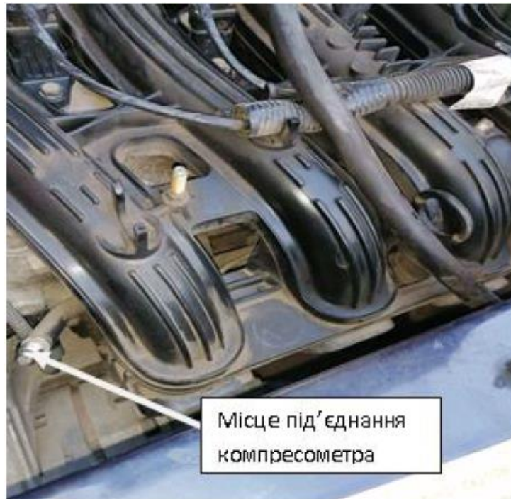
Рис.2.4. Діагностичний адаптер акумуляційної шини.
