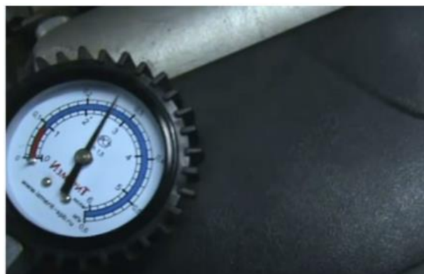
Рис.2.8. Знижений тиск палива в рампі.
