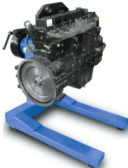
Рис. 3.2. Універсальний стенд для монтажу та демонтажу двигунів Р1250.
