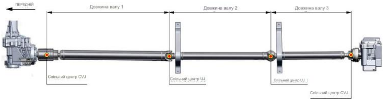
Рис. 2.12. Виміри та положення на карданному валі.
