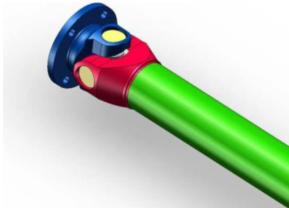
Рис. 3.4. Моделювання карданної передачі в Solidworks (деталь).
