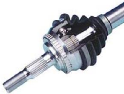
Рис. 1.1. Поперечний розріз кулькового шарніра.
