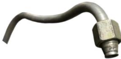
Рис. 4.7. Сталева трубка високого тиску.
