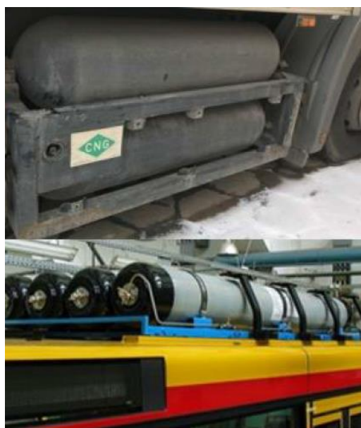
Рис. 4.9. Спосіб монтажу балонів композитно-алюмінієві на рамі вантажівки; композитні на даху міського автобуса.
