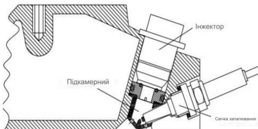
Рис. 1.10. Розташування інжектора, передкамери та свічки запалювання в двигуні.
