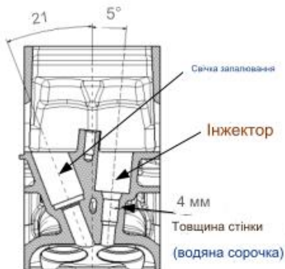
в) поперечний переріз свічки запалювання та інжектора (модифікована модель).
