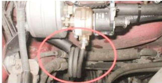
Рис. 4.8. Спосіб підключення випарника до жорсткої мідної трубки СПГ.
