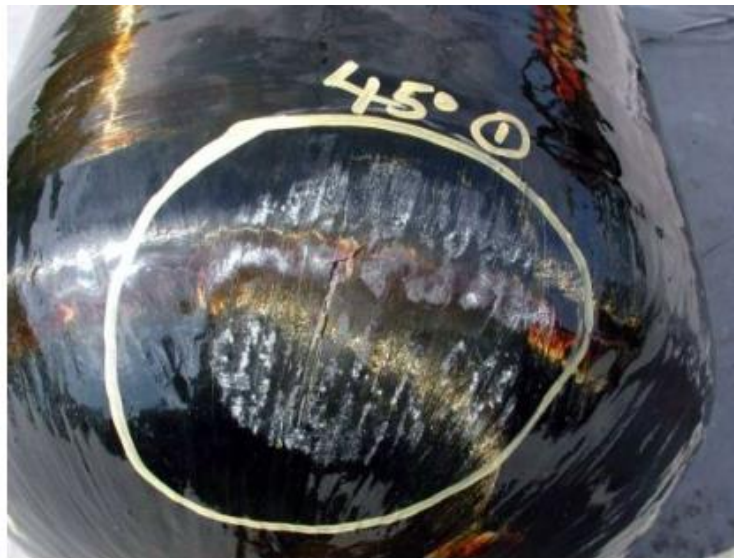
Рис. 4.1. Наслідки ударного випробування композитного балона для СПГ.
