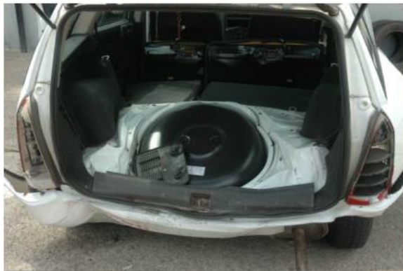
Рис. 4.10. Задня частина автомобіля з торіодальним балоном СПГ після зіткнення.
