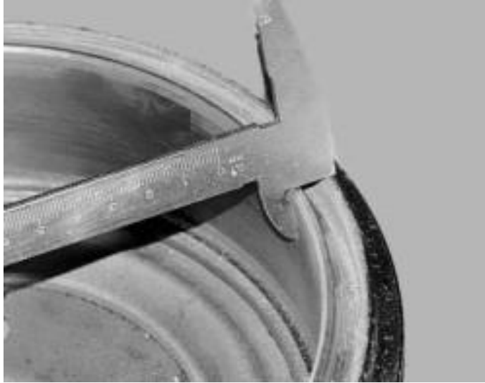
Рисунок 2.11 –Вимірювання діаметра робочої поверхні гальмівного барабана
