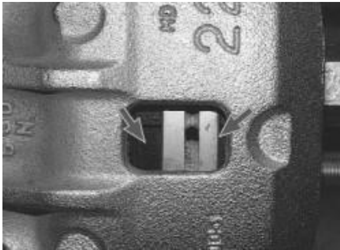
Рисунок 2.9 – Отвір в супорті для перевірки товщини фрикційних накладок гальмівних колодок
