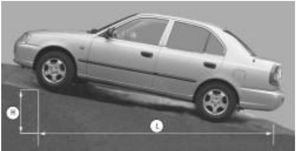
Рисунок 2.12 – Схема перевірки стоянкового гальма
