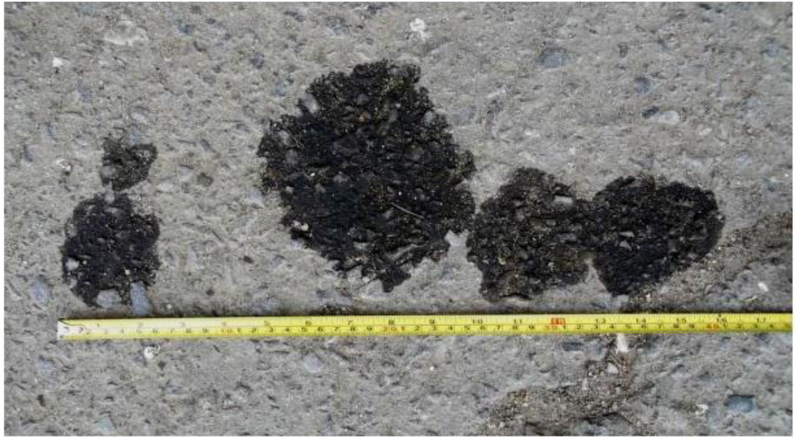
Рисунок 2.36. Вимірювання розмірів плям від палива та масла після того, як автомобіль поїхав
