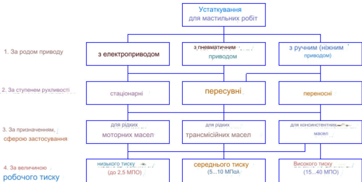
Рис. 3.1. Класифікація устаткування для змащувальних і заправочних робіт.
