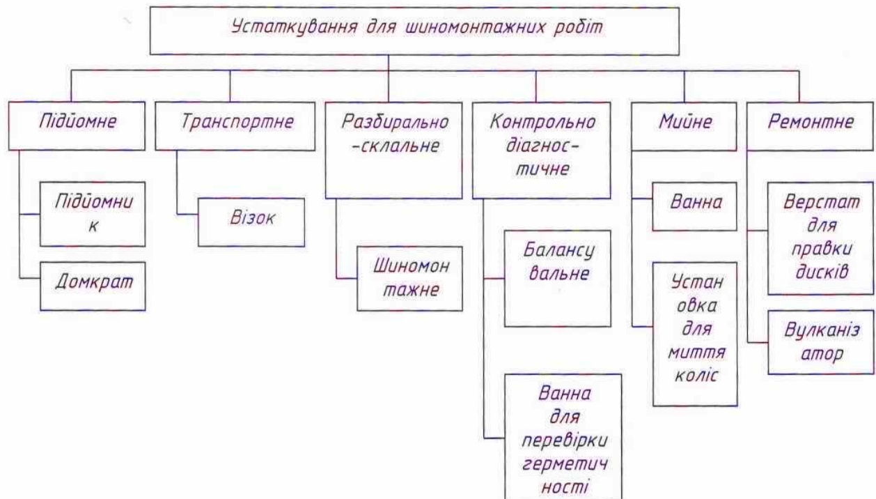
Рис. 2.1 План обладнання шиномонтажного відділу.
