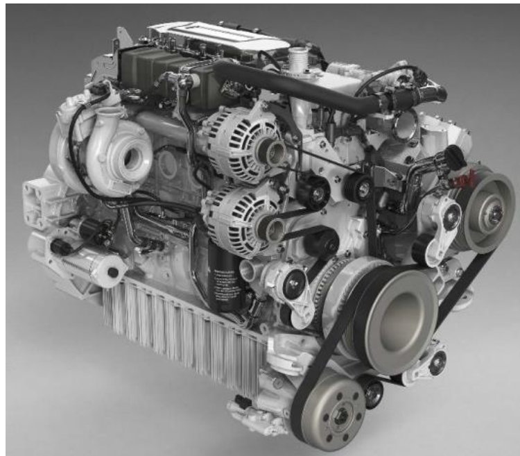
Рис. 1.3. Шестициліндровий рядний двигун Scania з об'ємом 7 літрів.
