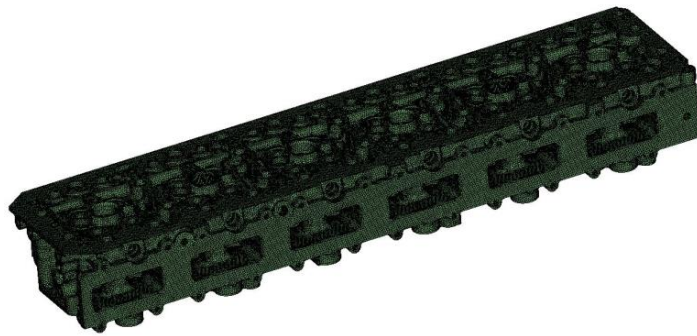
Рис. 2.14. Сітка на головці циліндрів. Розмір елементів сітки вельми малий, близько 3.4 мм.
