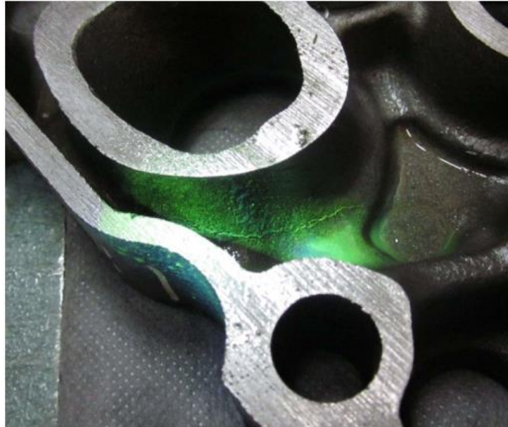
Рис. 2.5. Тріщина, що проходить крізь матеріал, підсвічена Magnaflux та ультрафіолетовим світлом.
