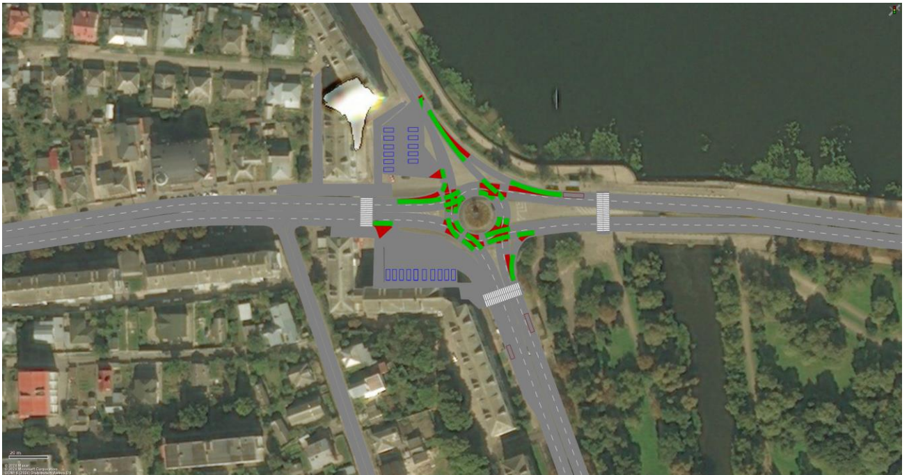
Рисунок 2.9– Схема розв'язання конфліктних зон на перехресті
