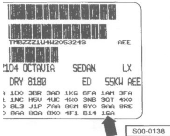
Рис. 2.1 Приклад маркування шасі зі стандартною ходовою частиною 1GA
