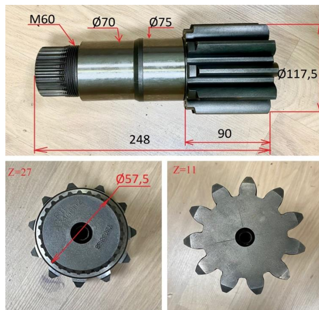
Рисунок. 2.1 Робоче креслення ведучої вал-шестерні головної передачі автомобіля
