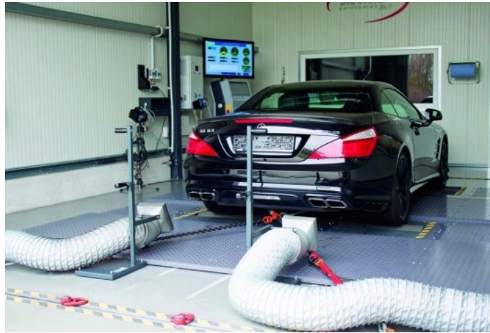
Рисунок 3.1 – Стенд для вимірювання тягово-швидкісних характеристик
