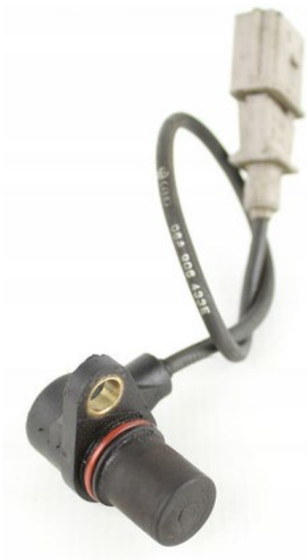
Рисунок 2.3 – Датчик положення колінвалу Audi A4 B6 2.0 FSI AWA
