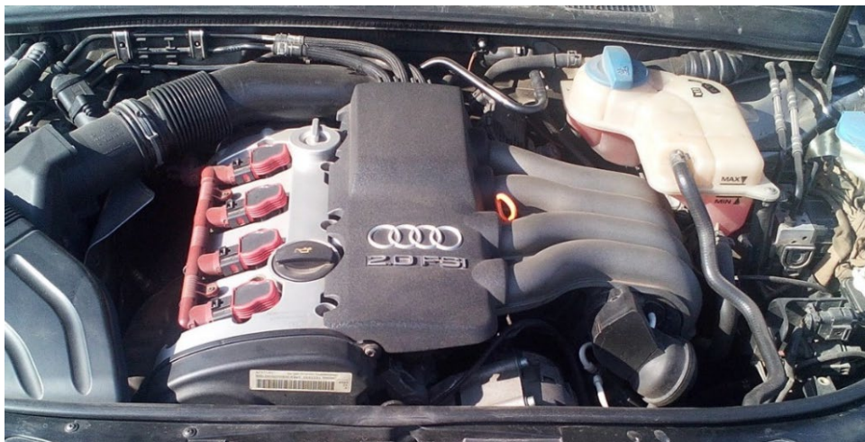
Рисунок 1.2. – Двигун 2.0 FSI (AWA): двигун: тип: Бензиновий, рядний, 4-циліндровий; об'єм: 1984 см 3 ; діаметр циліндрів *
