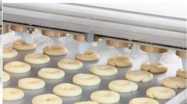
Рис. 1.4. – Формування тістових заготовок машинами системи Babydrop
