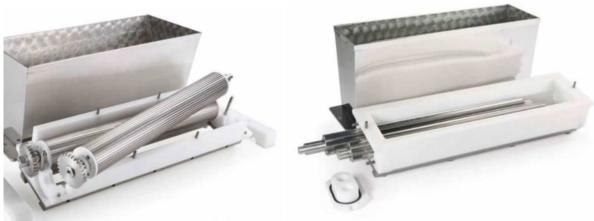
Рис. 1.9. - Відсаджувальні головки машин системи Doble для виробництва печива з начинкою
