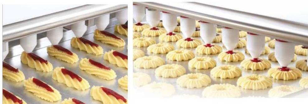
Рис. 1.10. – Формування тістових заготовок з начинкою машинами системи Doble
