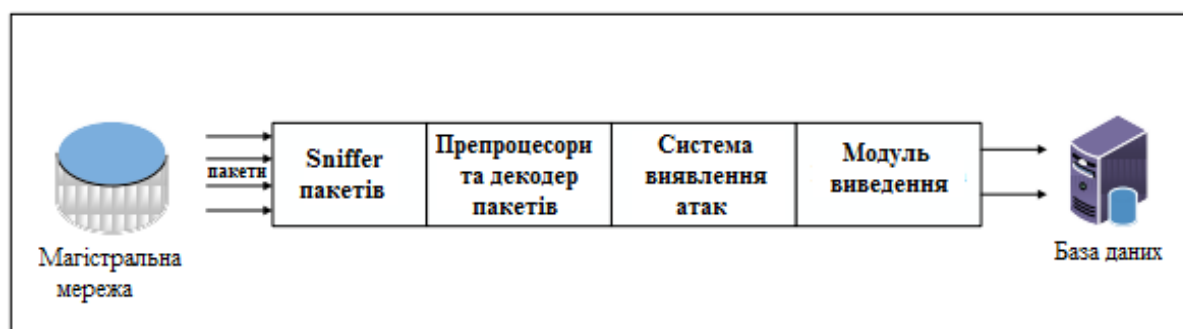
Рисунок 1.1 – Функціональна схема системи IDS Snort
