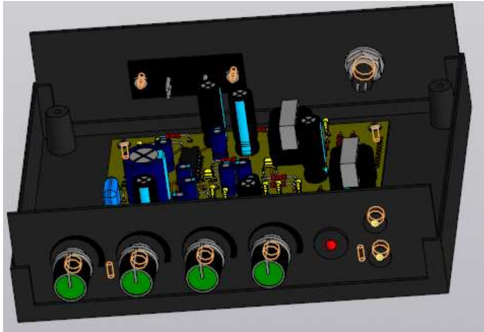
Рисунок Б.3– 3D модель пристрою, нижня кришка
