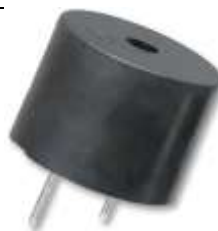
Рисунок 2.8- Зовнішній вигляд випромінювача звуку НРМ14АХ
