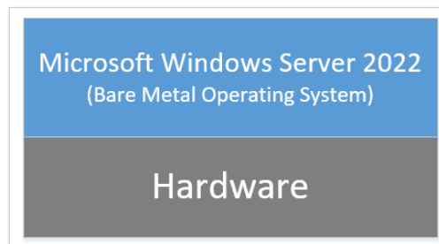
Рисунок 2.4 – Windows Server 2022 встановлений безпосередньо на фізичному обладнанні
