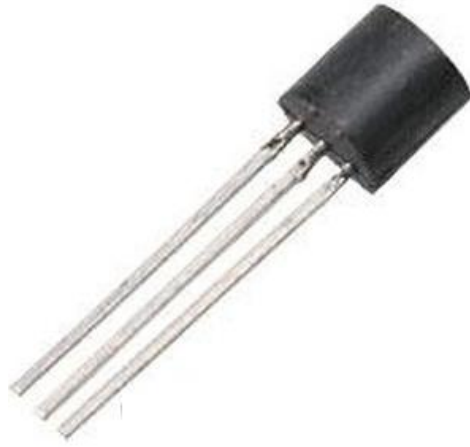
Рисунок 2.8- Зовнішній вигляд транзистора BC546A "ON Semiconductor"
