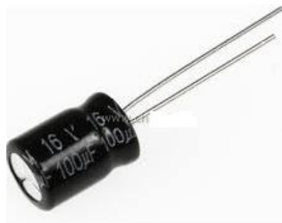
Рисунок 2.1- Зовнішній вигляд конденсатора типу ЕСАР
