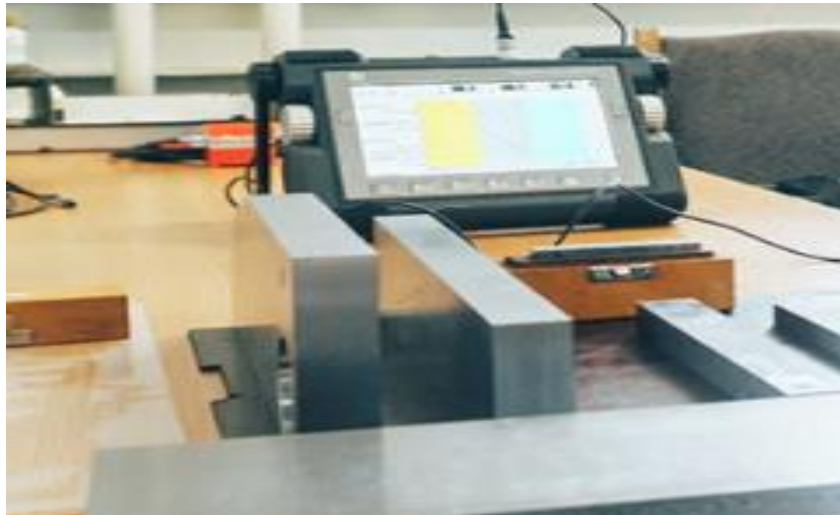
Рисунок 2.12 – Засоби для проведення ультразвукового контролю
