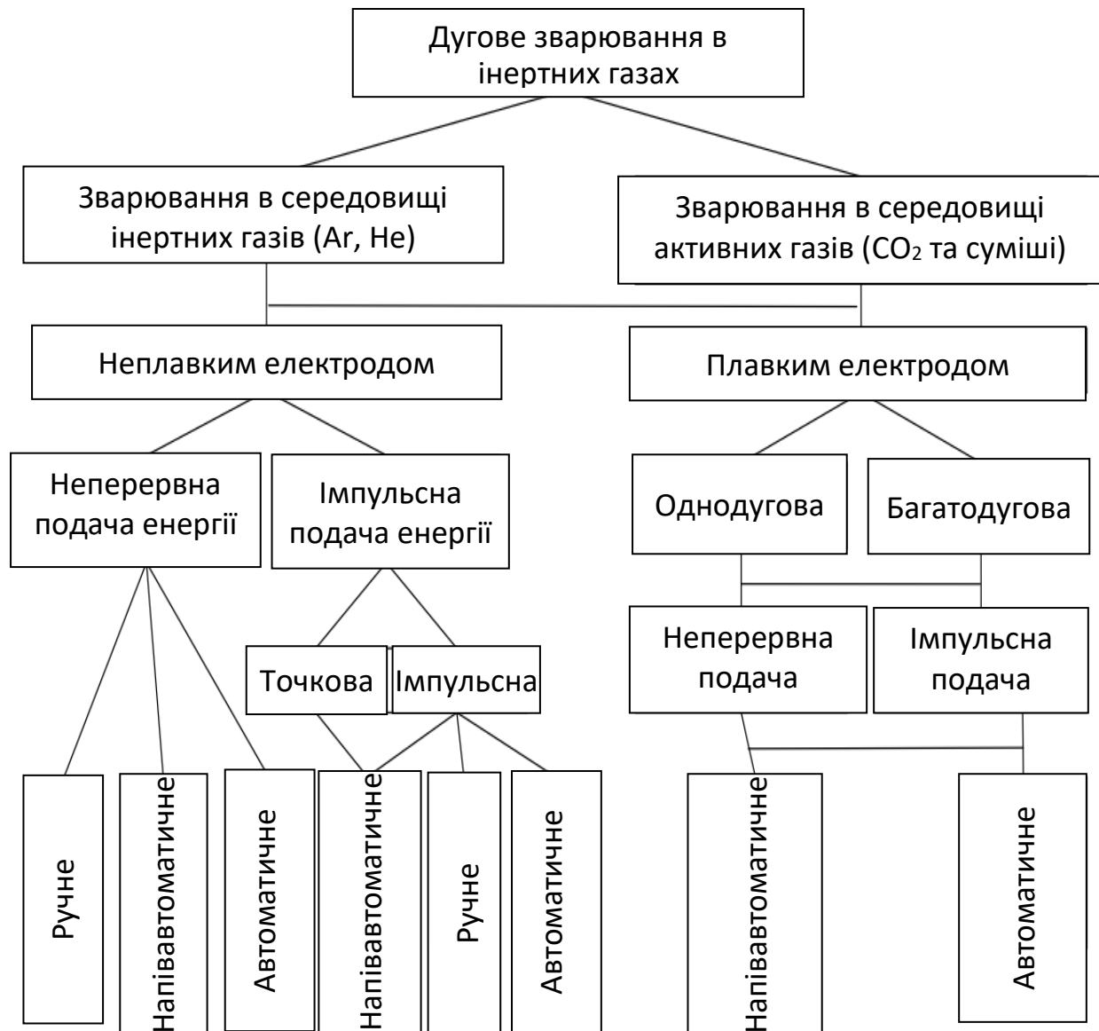
Рисунок 2.1 – Способи дугового зварювання в захисних середовищах
