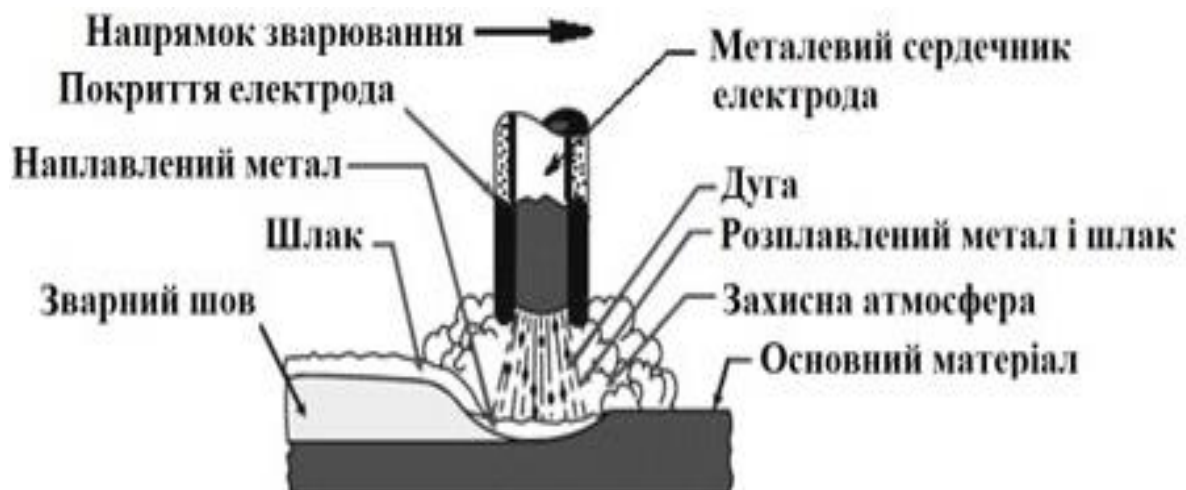
Рисунок 1.5 – Ручне дугове зварювання
