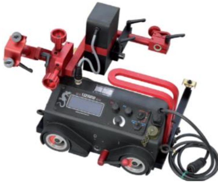
Рисунок 2.5 – Загальний каретки Lizard
