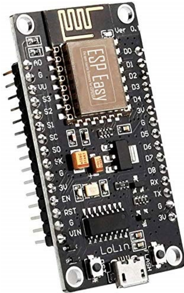
Рисунок 2.4 – Зовнішній вигляд NodeMCu
