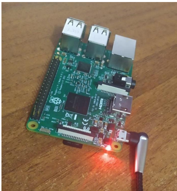
Рисунок 3.11 – Плата Raspberry Pi Uno 3 В підключена до живлення.
