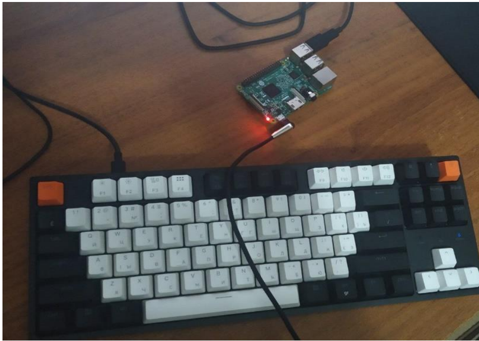
Рисунок 3.12 – Плата Raspberry Pi 3 Uno B підключена до клавіатури
