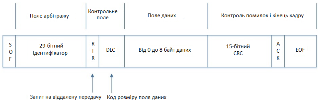
Рисунок 1.3 – Структура пакету повідомлення CAN
