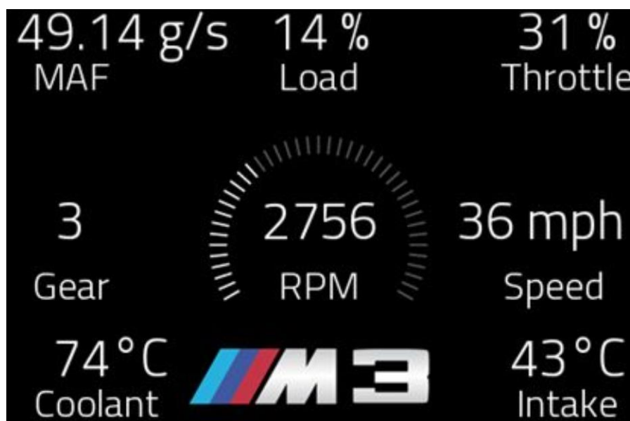
Рисунок 3.35 – Графічний інтерфейс системи зчитування та відображення показників двигуна авто
