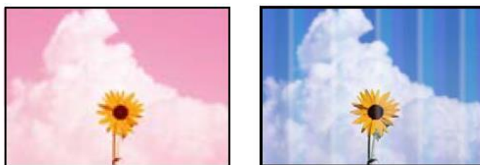
Рисунок 2.29 – Приклад дефекту не відповідності кольорів та поява вертикальних смуг
