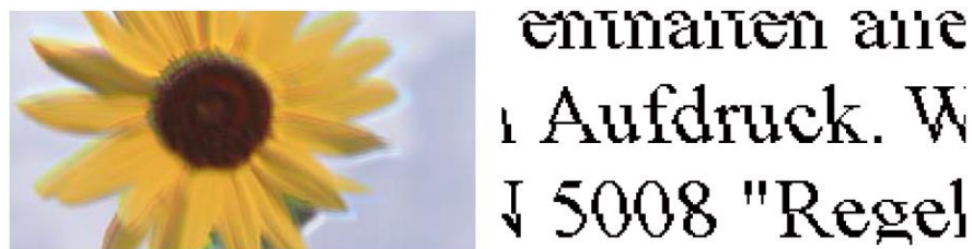
Рисунок 2.32 – Приклад дефекту розмитості роздруківки та неоднорідність ліній
