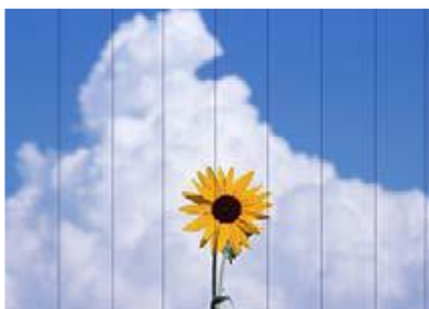
Рисунок 2.31 – Приклад дефекту вертикальних смуг із однаковим інтервалом
