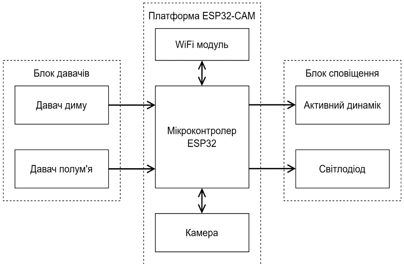
Рисунок 2.2 – Структурна схема пристрою для контролю за дотриманням заборони паління у приміщеннях
