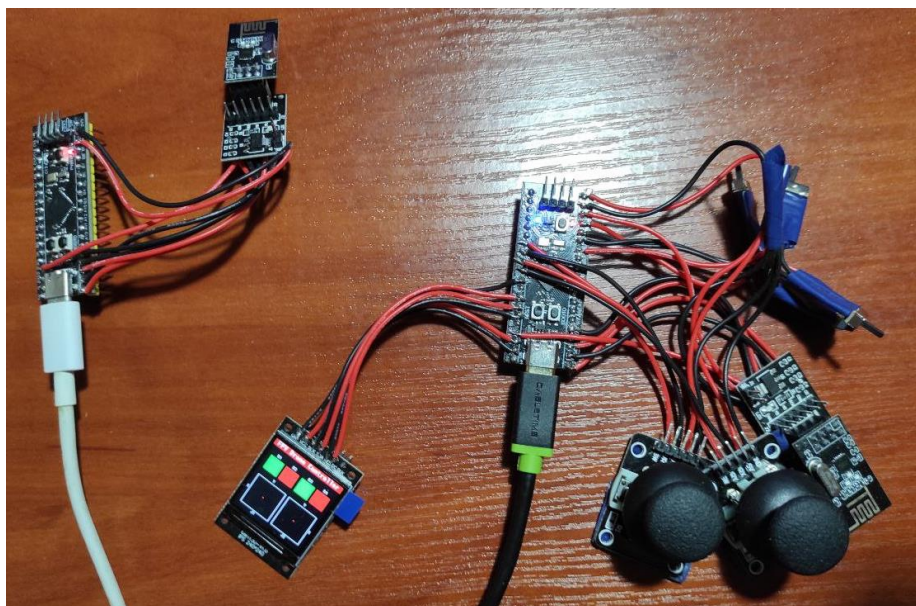
Рисунок 3.27 – Прототип системи керування FPV дроном для симулятора польоту
