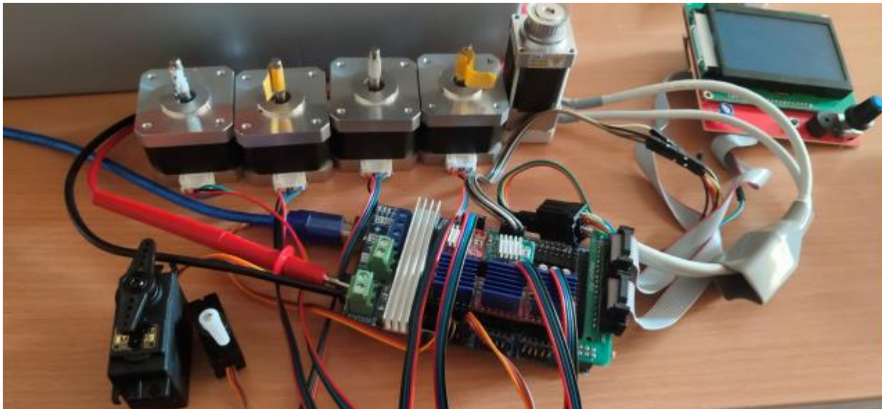
Рисунок 3.3 – Зібрана система автокалібрування столу 3D -принтера
