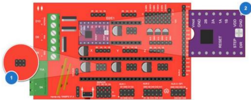
Рисунок 2.11 – Під'єднання TMC2225 до RAMPS 1.6
