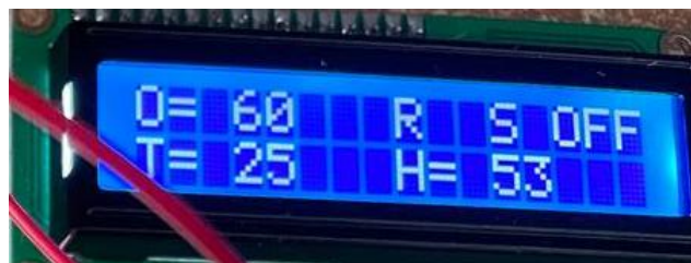
Рисунок 3.13 – Реакція пристрою, на критичний рівень кисню, при ручному режимі
