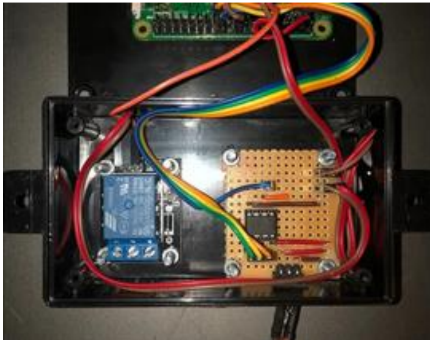
Рисунок 2.16 – Змонтована система управління підігрівом води від сонячних колекторів
