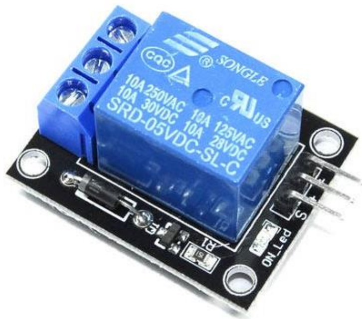
Рисунок 2.11 – Блок реле системи підігріву води у басейні
